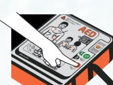
電気ショックが必要な場合は、音声ガイダンスに従い、点滅している電気ショックボタンを押してください。
