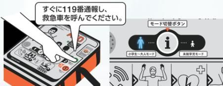
電源ボタンを長押しし、AEDの電源を入れます。モード切替ボタンで、小学生～大人モード/未就学児モードを適切に選択してください。
