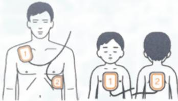
選択したモードの傷病者の電極パッド貼付位置をイラストと光によってガイドします。
